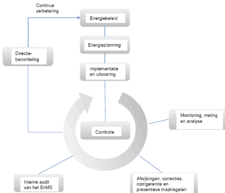
Figuur. Model van een energiemanagementsysteem (bron ISO 50001)
